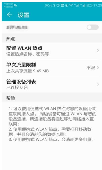
图 2-9 便携式 WLAN 热点设置界面
